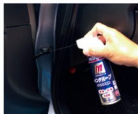
ドアヒンジなどプレートの隙間に浸透して潤滑
