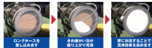
施工前 D-2注入後 再生後
