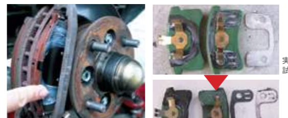
ディスクブレーキの鳴き止めに 実車耐久試験前 実車耐久試験後
